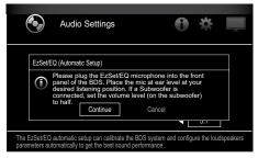
8. Observez le silence le plus total pendant l'essai acoustique via les enceintes. Lors de l'essai acoustique, l'interface indique l'enceinte testée.
